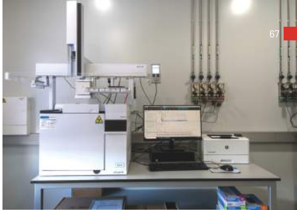
Cromatògraf de gasos per l'anàlisi de TPH (hidrocarburs totals C10-C40 i fraccions totals).
